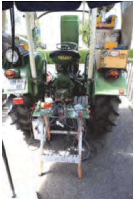
Anfänglich hingen überall noch die Strippen raus, aber das änderte sich bald. Allerdings dauerte die komplette Verkabelung viel länger als ursprünglich gedacht. Es ist aber auch einiges hinzugekommen: Lichthupe, Bremslicht, Tagfahrlicht, Arbeitsscheinwerfer, Nebelscheinwerfer und Zusatz- Fernlicht abnehmbar, Kabinenbeleuchtung, Vorbereitung für Elektrolüfter, Vorbereitung für Rundumkennleuchte ...
