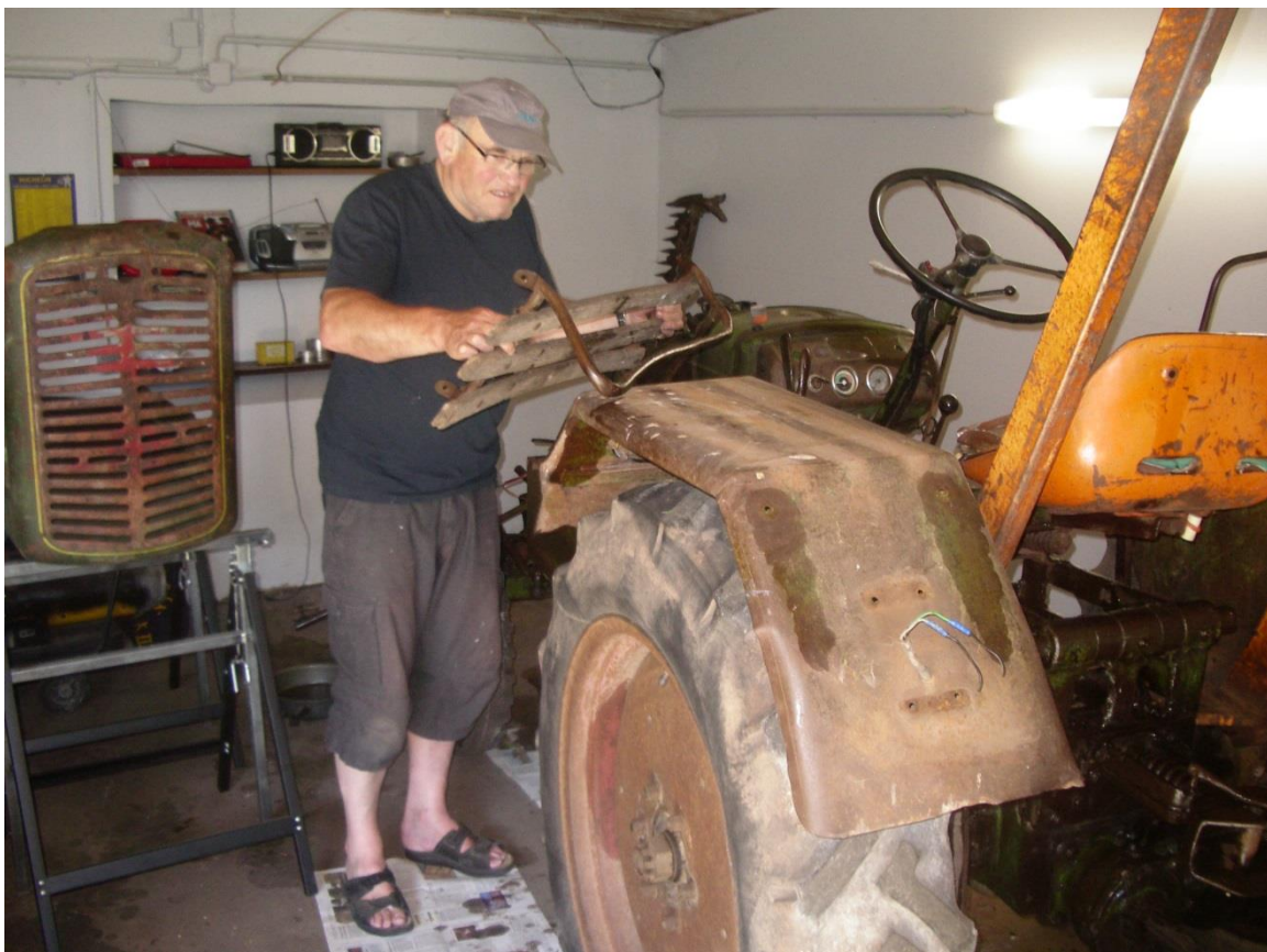
18.08. Weiterer Arbeitseinsatz. Motor warm laufen lassen. Auf Dichtheit prüfen. Nur leichtes „Schweißen“ von Öl an der Flanschverbindung Motor Kupplungsglocke. .Ansonsten ist nicht mehr viel alte Farbe am Fahrzeug. Der Schlepper wird aufgebockt und auf Unterstellböcke gestellt. Räder vorne und hinten werden abmontiert.
