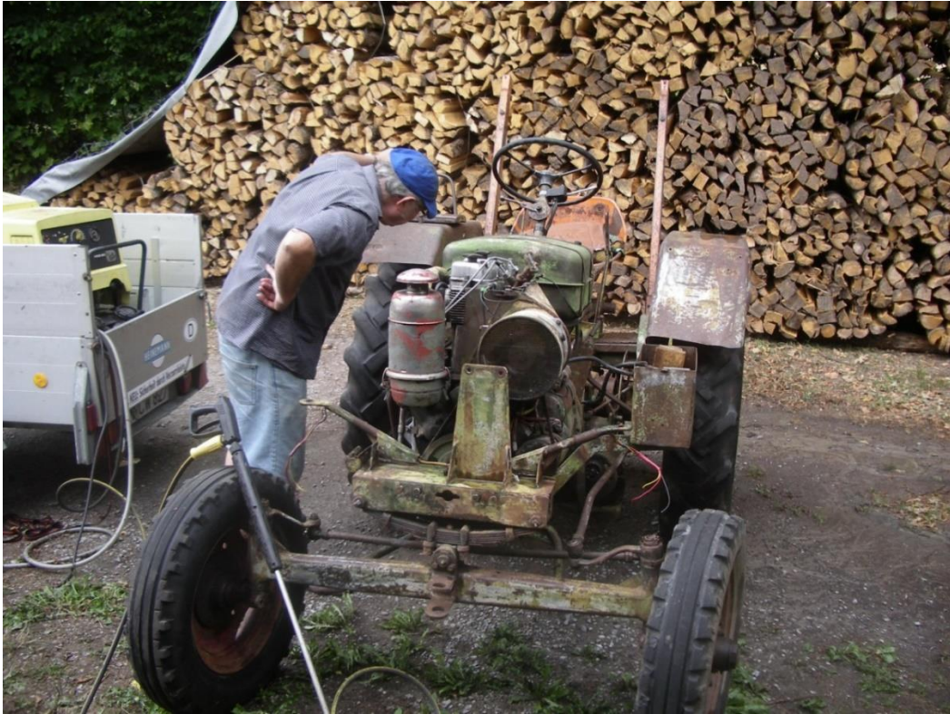
18.08. Weiterer Arbeitseinsatz. Motor warm laufen lassen. Auf Dichtheit prüfen. Nur leichtes „Schweißen“ von Öl an der Flanschverbindung Motor Kupplungsglocke. .Ansonsten ist nicht mehr viel alte Farbe am Fahrzeug. Der Schlepper wird aufgebockt und auf Unterstellböcke gestellt. Räder vorne und hinten werden abmontiert.
